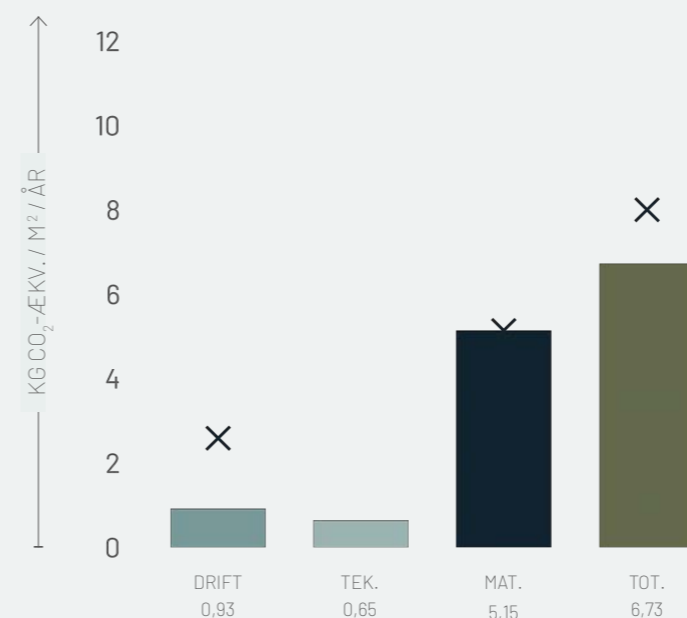
Figur E08.1: Udledningen af kg CO 2 -ækv. / m 2 / år Søjlerne viser bygningens klimapåvirkning. Krydsene indikerer det højeste resultat for drift, materialer og samlet udledning af kg CO 2 -ækv. / m 2 / år i casesamlingens etageboliger.
